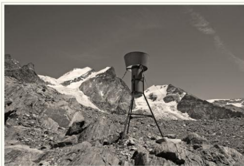
Pluviometro totalizzatore nei pressi del rifugio Mezzalama 3036 m.
